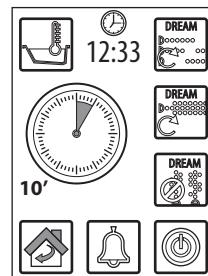
La baignoire est dotée d'un réchauffeur qui s'active automatiquement quand l'hydromassage Whirlpool est en fonction pour empêcher que l'eau ne refroidisse trop rapidement.
