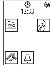
Als er geen apparatuur aangesloten is verschijnt rechtsboven het symbool met het knipperende doorgekruiste Bluetooth signaal.
