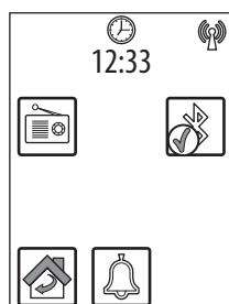
Jeżeli nie ma podłączonych urządzeń, na górze, po prawej stronie pojawi się migająca ikona przekreślonego sygnału Bluetooth.
