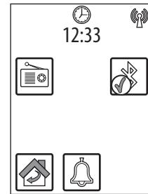
Si aucun dispositif n'est branché, une icône avec le signal Bluetooth barré et clignotant s'affichera en haut à droite.
